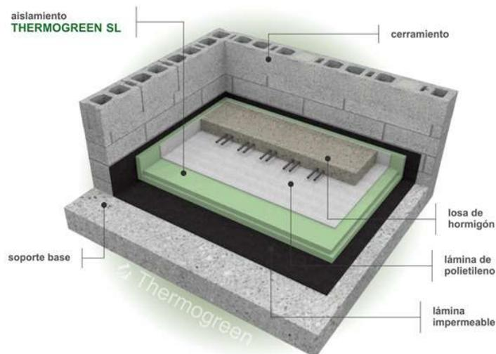
Ejemplo de aplicación en aislamiento de muros enterrados:
